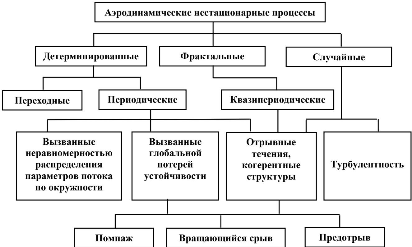
Рисунок 2.7.1 – Классификация нестационарных процессов в турбомашинах
