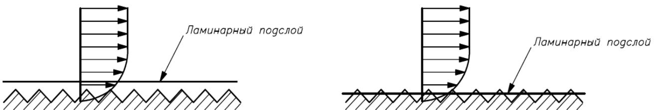
Рисунок 2.6.4 – Схема гидравлически гладкой (слева) и шероховатой (справа) поверхностей
