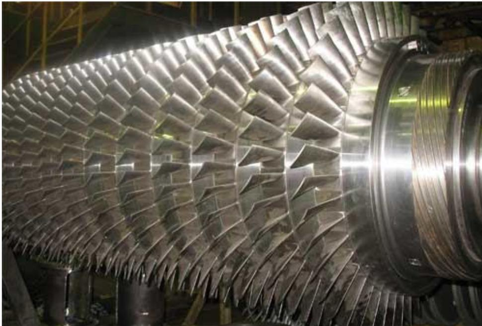
Рисунок 2.5.2 – Ротор осевого компрессора
