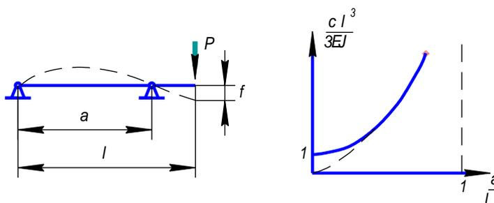
Легко видеть, что при  $a \rightarrow 0$  коэффициент жесткости оказывается отличным от нуля - ведь в этом предельном случае обе опоры точно совпадают и система из геометрически неизменяемой превращается в механизм, неспособным сопротивляться, т.е. жесткость должна быть равной нулю.
