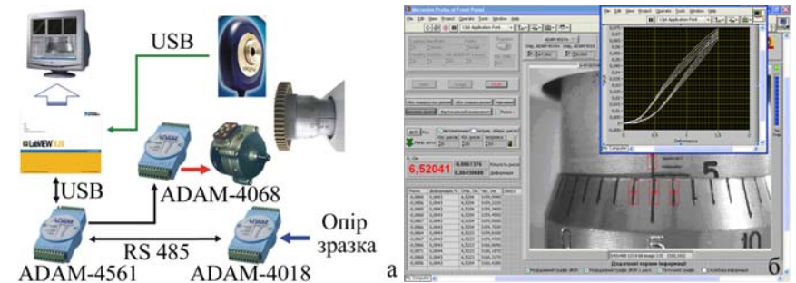
Рис. 2. Структурна схема автоматизованої системи дослідження тензоефекту (а) та інтерфейс програмного забезпечення (б)
