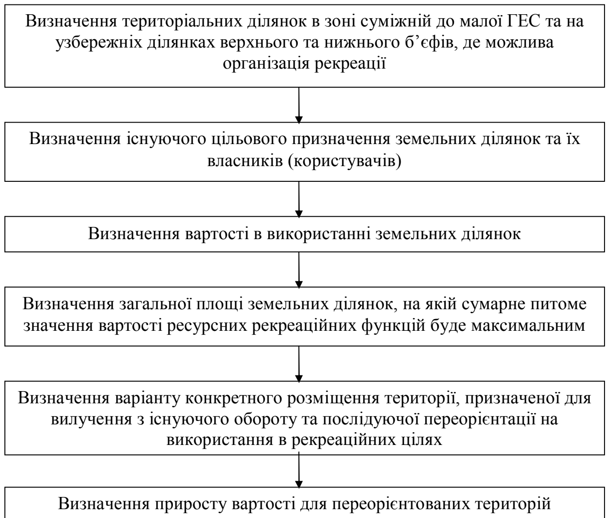
Рисунок 2.6 – Алгоритм вибору найбільш ефективних рішень при організації рекреаційного використання територій, прилеглих до малої ГЕС
