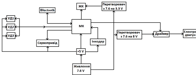
Рисунок 1 – Структурна схема розробленого мобільного робота: МК-мікроконтролер; ЖК-рідкокристалічний дисплей; УД1-3 – ультразвукові далекоміри 1-3.
