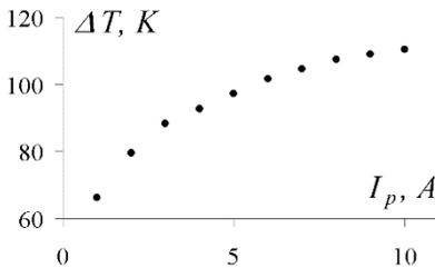
На рис. 1. представлена полученная зависимость  $\Delta T$  исследуемого диода в процессе работы от величины прямого тока  $I_p$  через диод.
