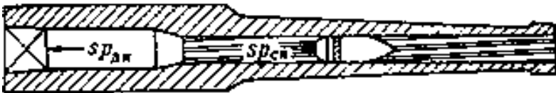
Рисунок 1 – Схема ствольного заряду звичайного артилерійського знаряддя
