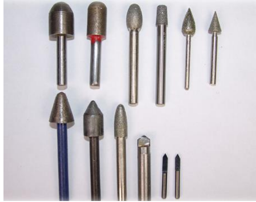
Рисунок 1.6 – Фрези з багатошаровим алмазним наконечником і напиленням
