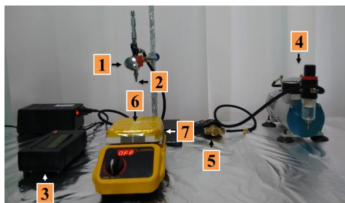
Рис. 2.2. Зображення експериментальної установки для нанесення плівок ZnO, CZTS методом пульсуючого спреї-піролізу: 1 – розпилювальний пістолет з резервуаром для початкового прекурсору, 2 – сопло, 3 – мікроконтролерний блок, 4 – компресор, 5 – електромагнітний клапан, 6 – підкладка, 7 – нагрівальна плитка [12, 13, 17]
