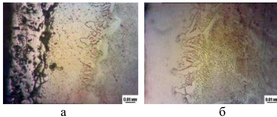
Рисунок 2 – Мікроструктура борхромових покриттів на сталях: а – У8; б – ХВГ
