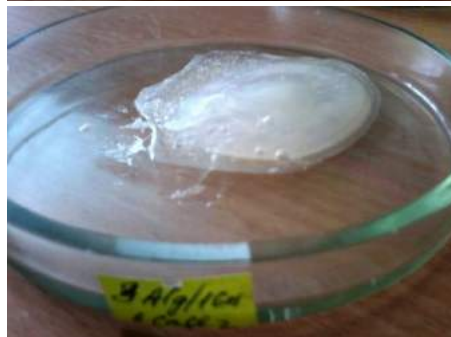
Рисунок – Плівки складу 3 Альг/1 Жел в 0,1 М розчинах ZnSO_4 (а) і CaCl_2 (б)
