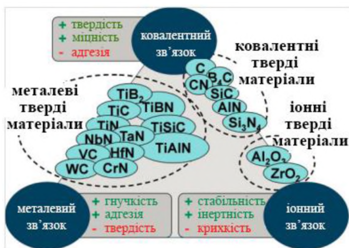
Рис. 1.1. Класифікація твердих керамічних матеріалів в залежності від типу хімічного зв'язку та відповідна зміна їх властивостей [10]
