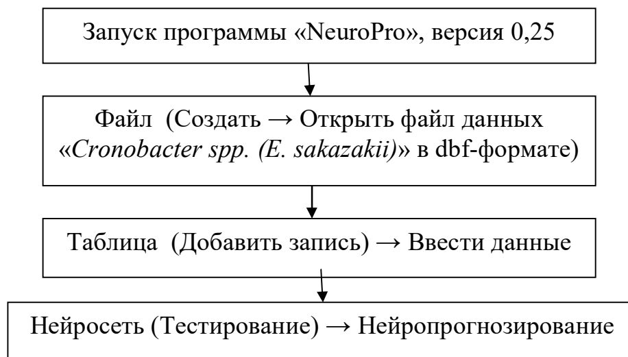
Рисунок 4.17 – Алгоритм дій при використанні методу прогнозування кількості Cronobacter spp. (E. sakazakii) в молоці з використанням комп'ютерної нейромережевої програми «NeuroPro», версія 0,25
