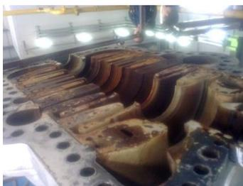
Рисунок 5 - Нижняя часть корпуса центробежного компрессора после долгих лет эксплуатации.
