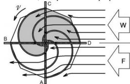
A,B,C,D — верхние опоры ротора; V — направление вращения ротора; W — зона захвата воздушного потока; F — зона обтекания воздушного потока
