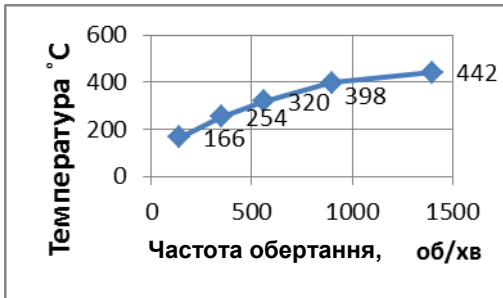
Рисунок 2 – Графік залежності температури від швидкості обертання
