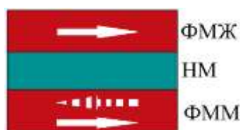
Рисунок 1.2 – Загальна структура псевдоспін-клапана:
