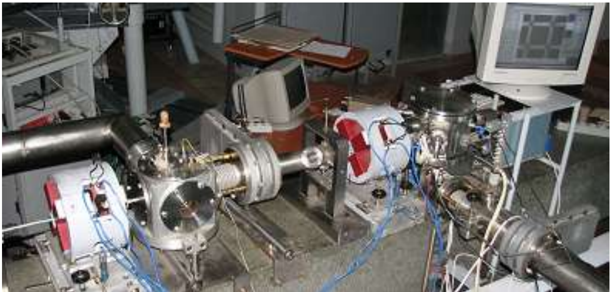
Рисунок 2.2 - Електростатичний прискорювач «Сокіл» з енергією пучка протонів до 2 МеВ
