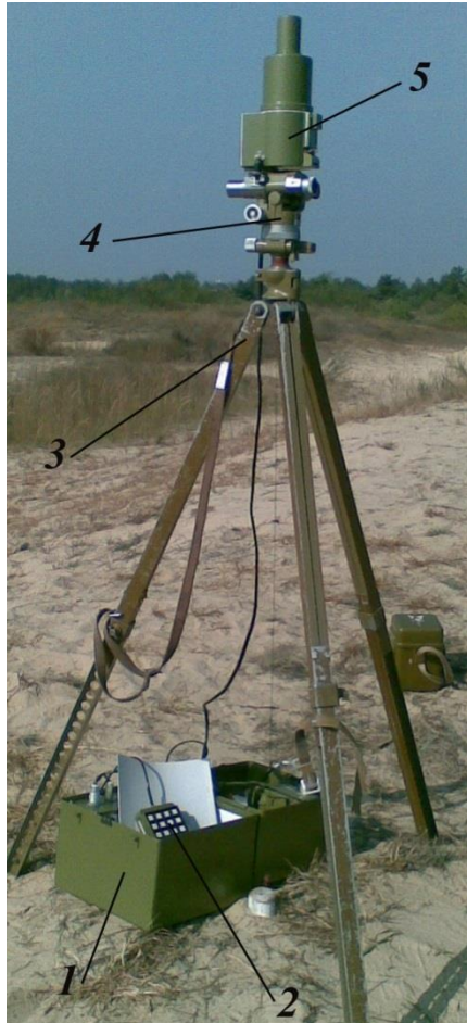
Рисунок 3.26 – Монтаж комплексу 1Г51У на тринозі з бусоллю ПАБ-2А: 1 – блок електроніки та живлення; 2 – блок керування; 3 – бусоль ПАБ-2А; 4 – насадка 1Г51У
