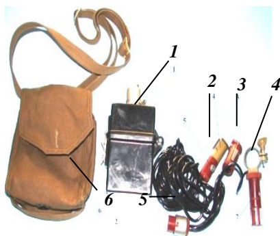
Рисунок 1.5 – Комплект освітлення: 1 – акумулятор; 2 – патрон освітлення сітки; 3 – патрон освітлення; 4 – віха; 5 – рознім; 6 – сумка
