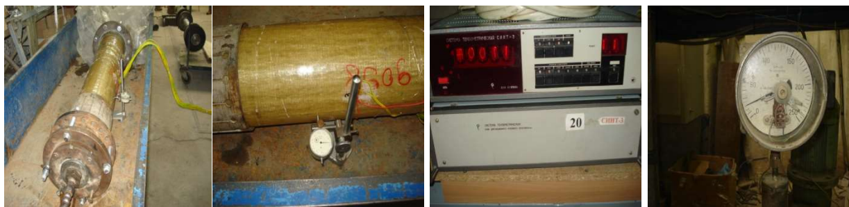
Рисунок 4.4 – Загальний вигляд установки для проведення гідростатичних випробувань
