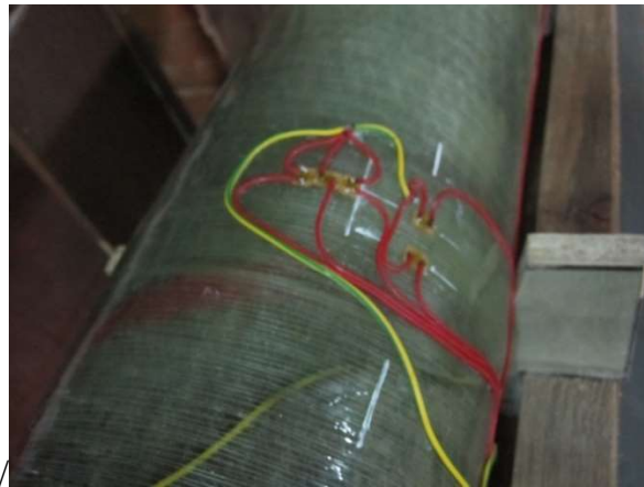
Рисунок 4.17 – Загальний вид розташування тензодатчиків на лицьовій поверхні бандажа
