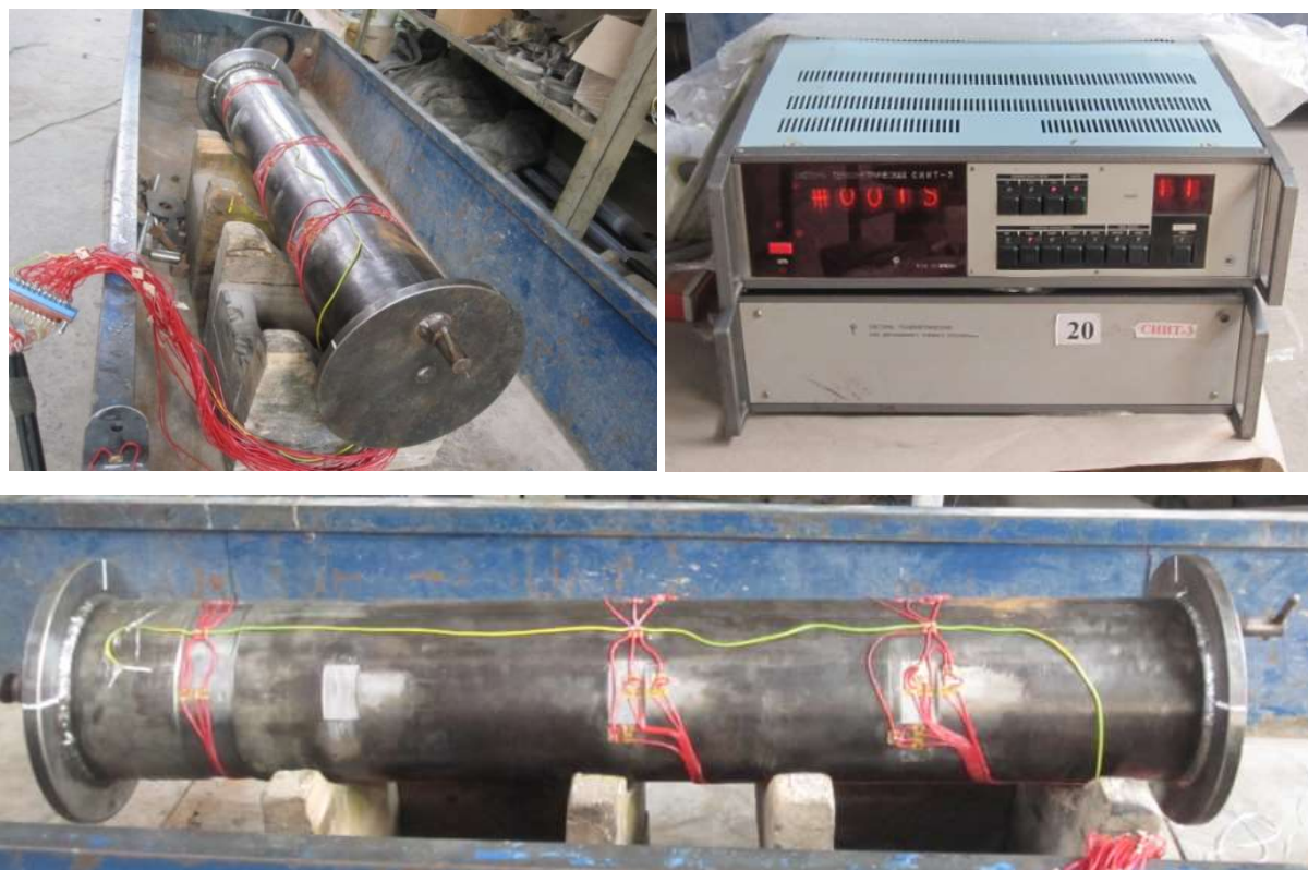
Рисунок 4.6 – Загальний вигляд експериментальної установки для гідростатичних випробувань
