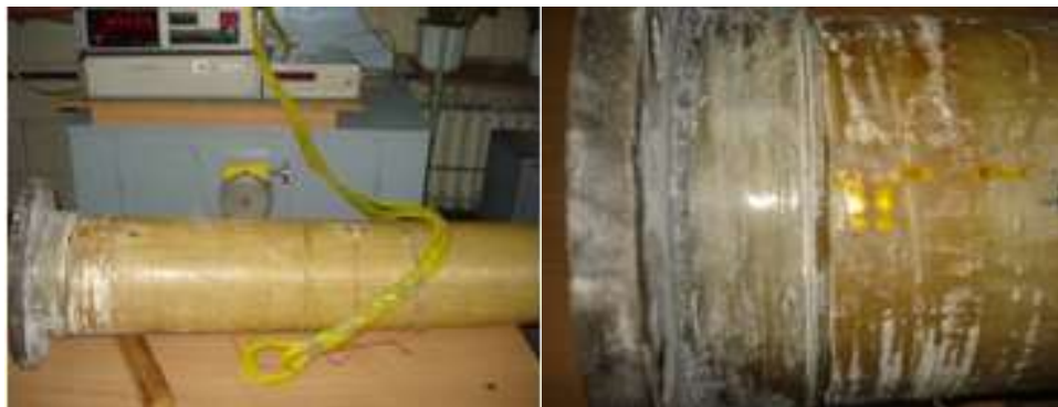
Рисунок 4.15 – Картина руйнування склопластику в зоні фланця
