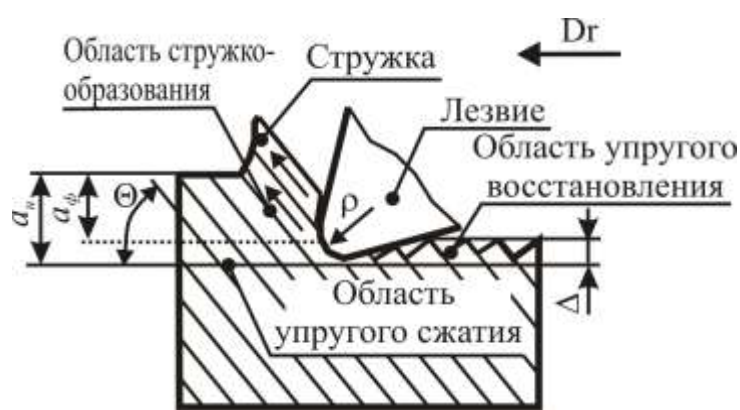
Рисунок 1.2 – Схема формування стружки при різанні лезом з округленою ріжучою кромкою [14]
