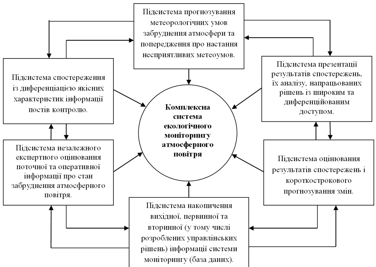
Рисунок 3.1 – Структурно-логічна схема взаємодії підсистем в межах комплексної системи екологічного моніторингу атмосферного повітря урбосистем [215]
