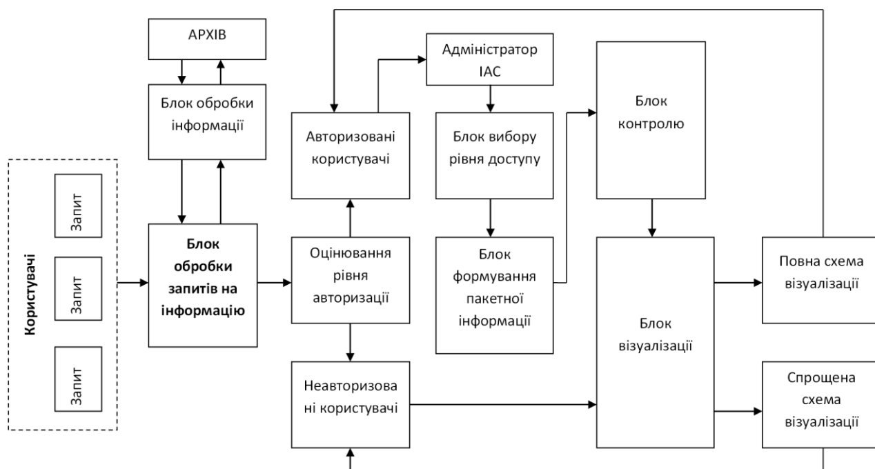
Рисунок 4.4 – Структура ІАС у частині обробки запитів на інформацію та її візуалізації
