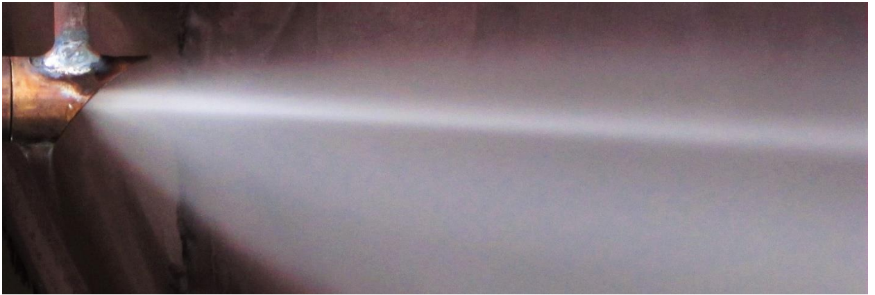
Рисунок 4.6 – Фотографія відхилення скипаючого потоку у косому зрізі сопла, що розширюється, при d_r = 2,3 мм, p_{01} = 5,04 бар, без недогріву
