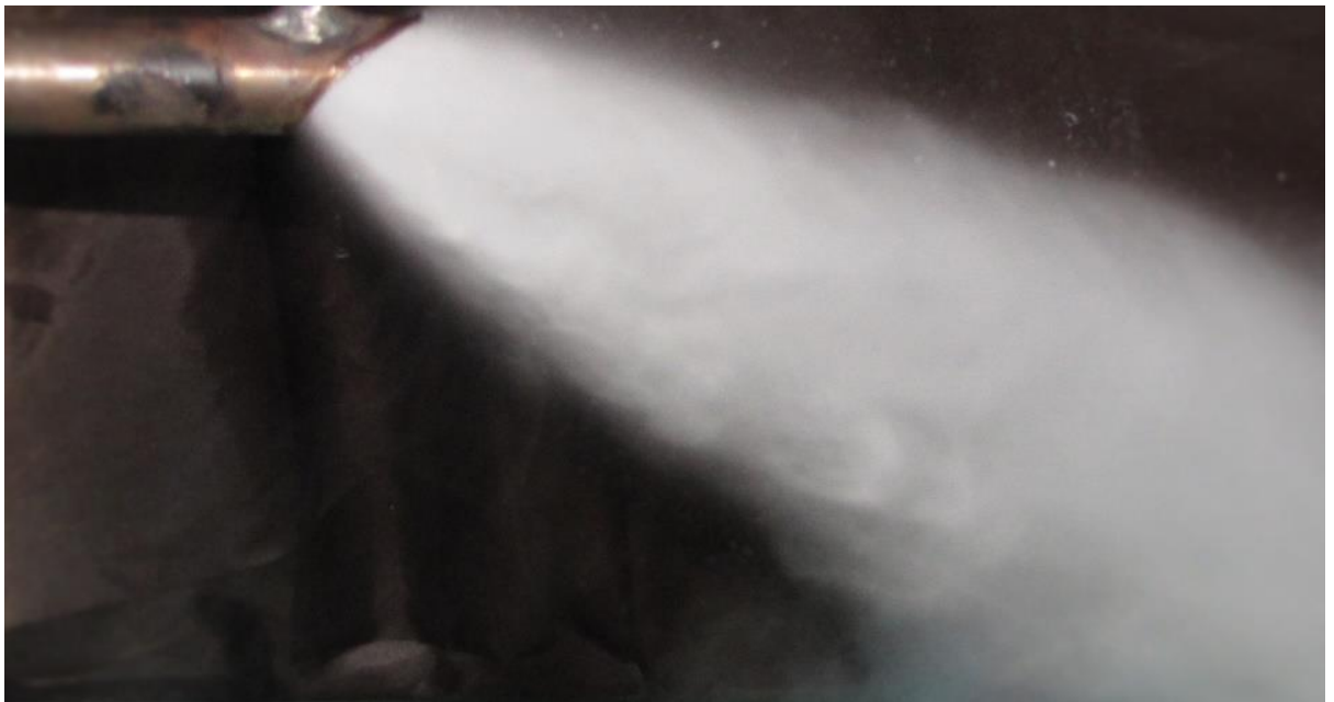
Рисунок 4.5 – Фотографія відхилення скипаючого потоку у косому зрізі сопла, що розширюється, при d_r = 4,1 мм, p_{01} = 5,04 бар, без недогріву
