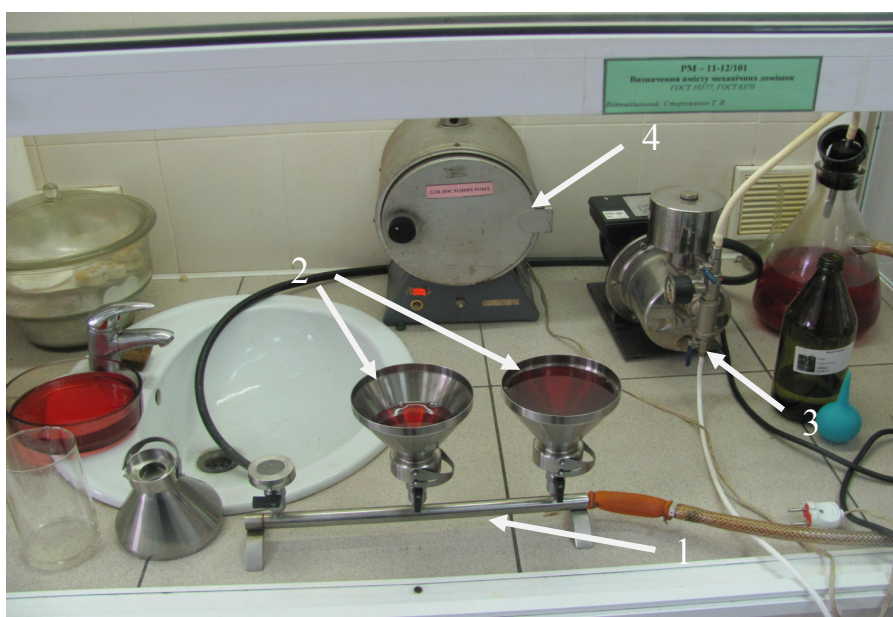
Рисунок 3.4. – Лабораторне обладнання для протягування проби крізь мембранний нітроцелюлозний фільтр: 1 – гребінка колектор; 2 – тримачі фільтрів; 3 – вакуумний насос; 4 – сушильна камера
