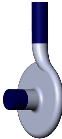
Рисунок 66 – Подовжені ділянки у тривимірній моделі розрахункової області корпуса
