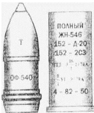
Постріл із повним змінним зарядом та ОФ снарядом
