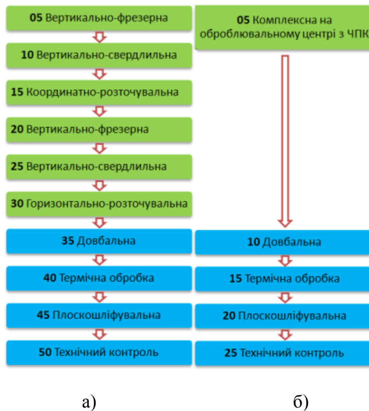
Рисунок 2.14 – Порівняння маршрутів обробки деталі «Важіль»:
