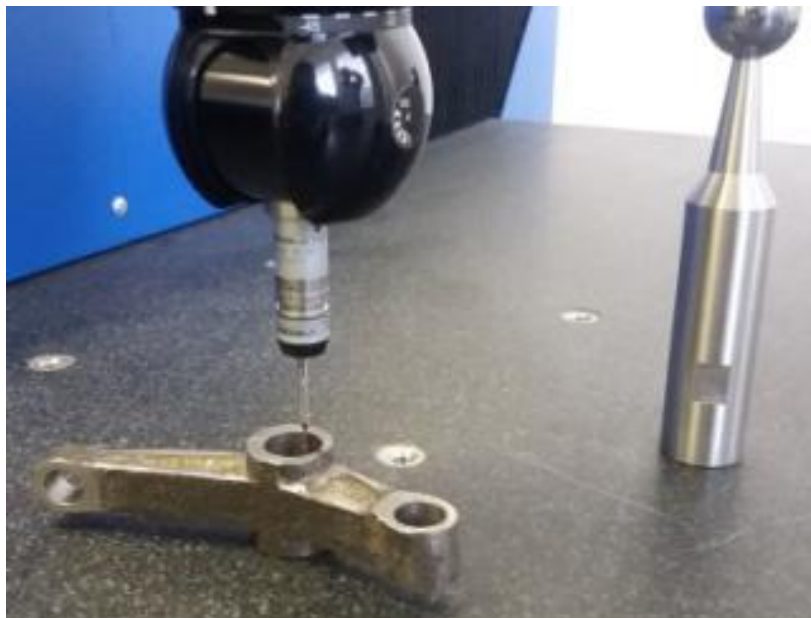
Рисунок 4.14 – Вимірювання розмірів бобишки головного отвору
