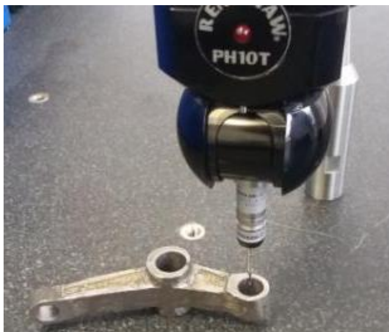
Рисунок 4.15 – Вимірювання розмірів бобишки допоміжного отвору, що паралельний головному
