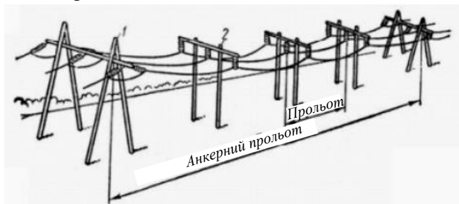
Рисунок 4.1 – Конструкційна схема однопровідної повітряної лінії:
