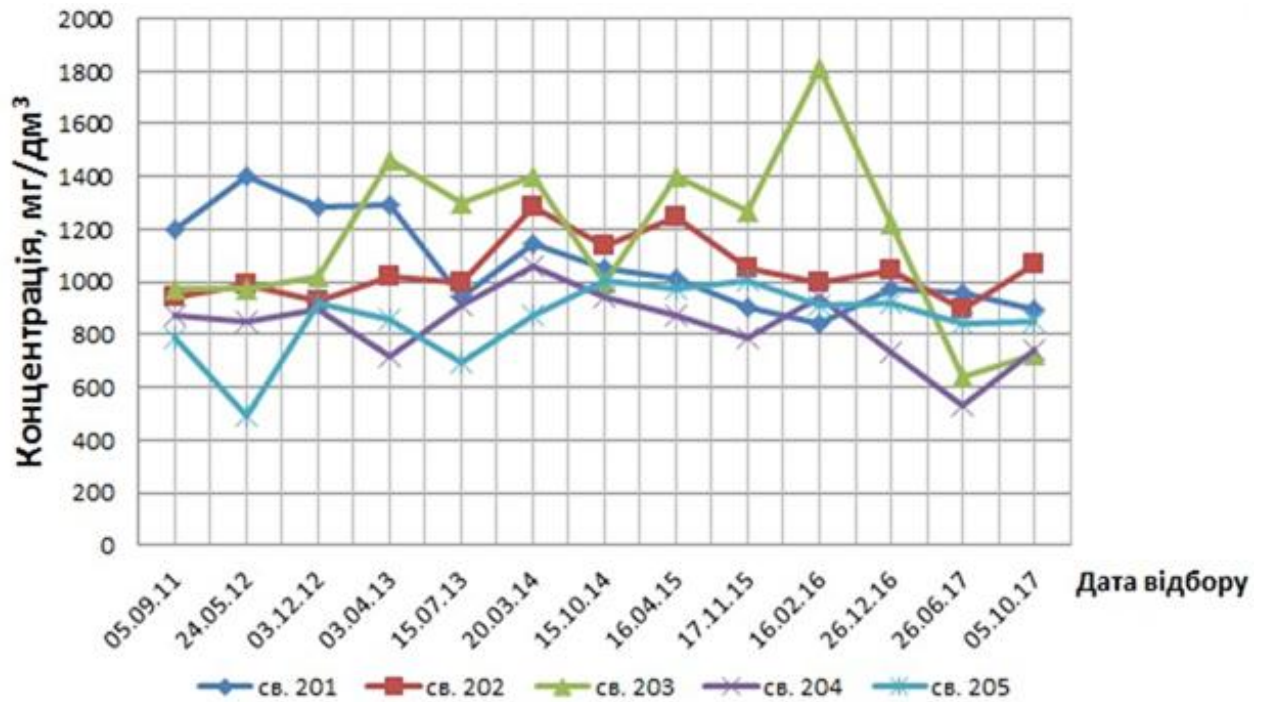
Рисунок 4.11 – Мінералізація підземних вод по спостережних свердловинам на майданчику золошлаконакопичувача
