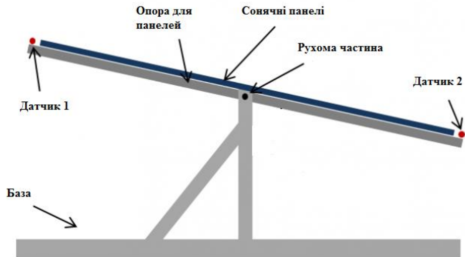
Рисунок 3.3 Схематичне зображення кріплення сонячних панелей
