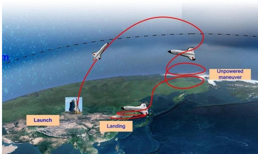
Рисунок 7.22 – Схема польоту китайського ракетоплана (Китай построи́т, 2016)
