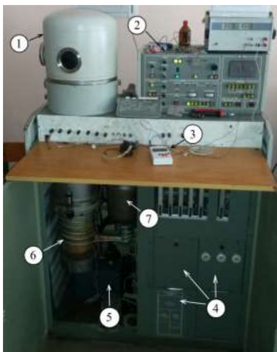
Рисунок 2.1 – Зовнішній вигляд вакуумного універсального поста ВУП-5М: 1 – робочий об’єм; 2 – блок керування та контролю; 3 – пульт дистанційного керування; 4 – блоки живлення; 5 – форвакуумний насос; 6 – висововакуумний насос; 7 – форвакуумний балон
