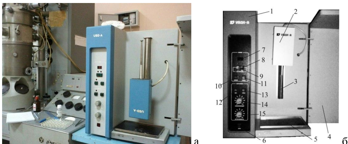
Рис. 2.5. Зовнішній вигляд ультразвукового диспергатора УЗДН-А (а) та його улаштування (б) [16]: 1 – блок живлення з панеллю керування; 2 – робочий випромінювач; 3 – насадка; 4 – дверцята шумозахисної камери; 5 – піддон з віброгасінням; 6 – кнопка ввімкнення живлення; 7 – індикатор таймера; 8 – кнопка ввімкнення таймера у хвиликах; 9 – кнопка ввімкнення таймера в секундах; 10 – кнопка програмування таймера; 11 – скидання таймера; 12 – кнопка ввімкнення випромінювача; 13 – зупинка випромінювача; 14 – ручка керування частотою синхронізації; 15 – ручка курування потужністю випромінювання
