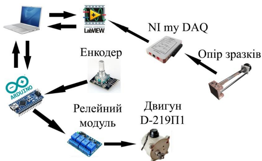
Рис. 2.19. Зображення загальної схеми інформаційної система контролю для дослідження тензорезистивних властивостей тонких плівок
