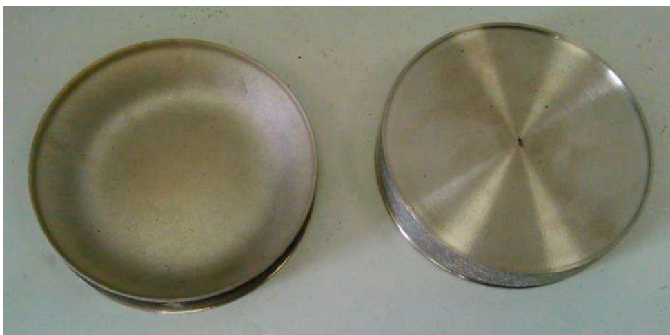
Рис. 2.2 - Катод в відпрацьованому і початковому станах
