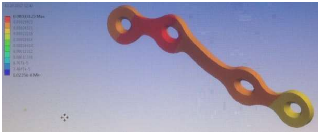
Рисунок 17 - Деформація пластини збільшена в 100 разів
