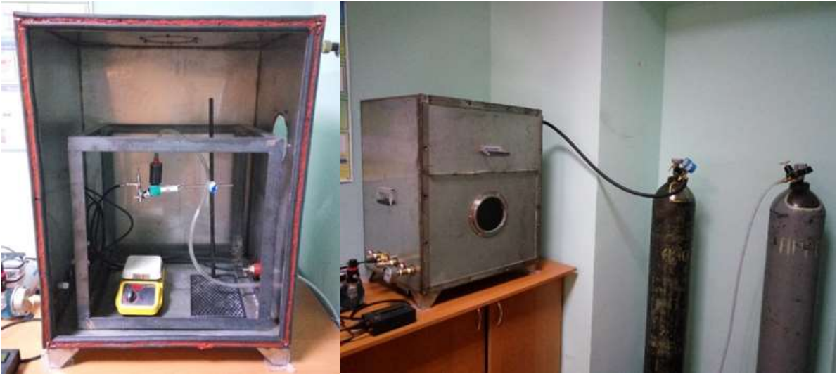
Рисунок 2 – Модернізована установка для нанесення плівок методом спреї-піролізу з металевою камерою для створення надлишкового тиску інертного газу аргону
