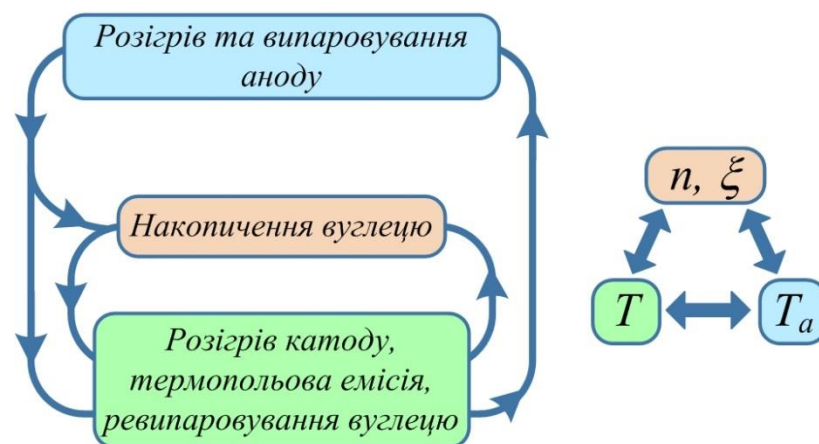
Рис. 7.5. Схематичне представлення нелінійно взаємопов'язаних процесів при самоорганізації технологічних умов формування БВНТ
