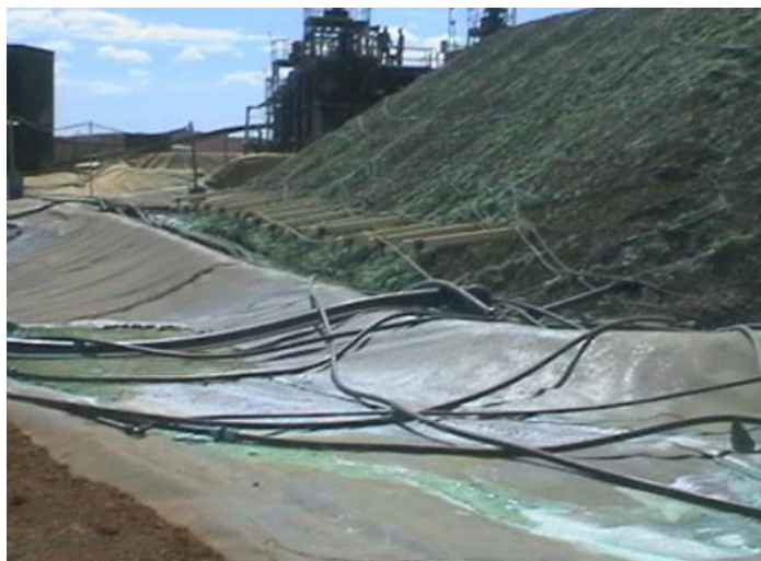
Рисунок 5.23 – Установка кучного бактеріального вилуговування на підприємстві «Радіо Хілл» (Австралія)
