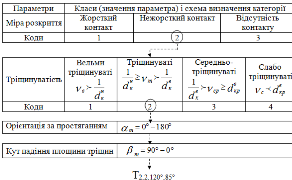
Рисунок 10 – Класифікація та схема визначення категорії блоків (природних окремоостей) у масиві гірських порід
