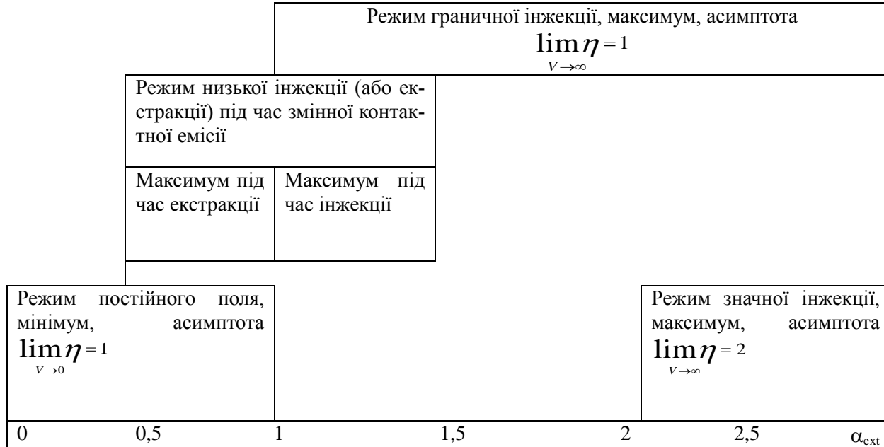
Рисунок 5.2 – Екстремуми й асимптоти ВАХ для різних бездифузійних режимів зарядоперенесення в структурах [24]
