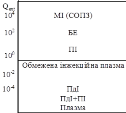
Рисунок 5.1 – Якісна діаграма значень коефіцієнта дискримінації залежно від домінуючого механізму зарядоперенесення в структурі. МІ – монополярна інжекція; БЕ – бар’єрна електропровідність; ПІ – польова інжекція; ПдІ – подвійна інжекція; ПдІ + ПІ – польова іонізація при подвійній інжекції носіїв
