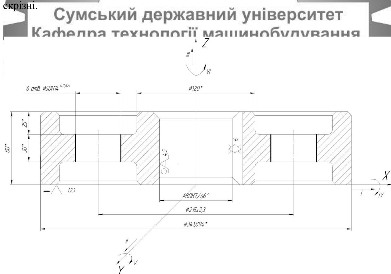
Рисунок 2.10 - Схема базування заготовки на свердлильній з ЧПК операції
