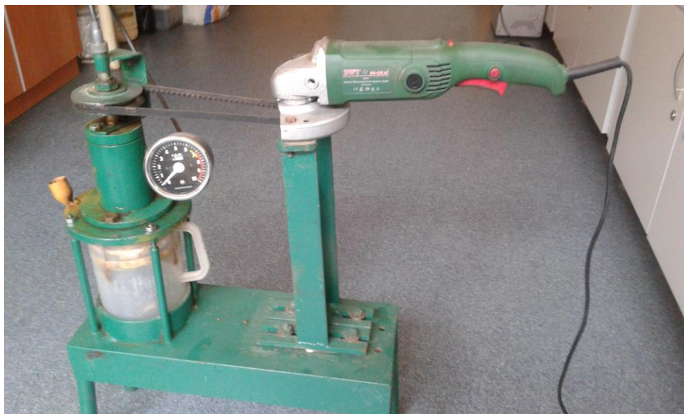
Рисунок 2.4 – Лабораторна установка для проведення гідродинамічної кавітації
