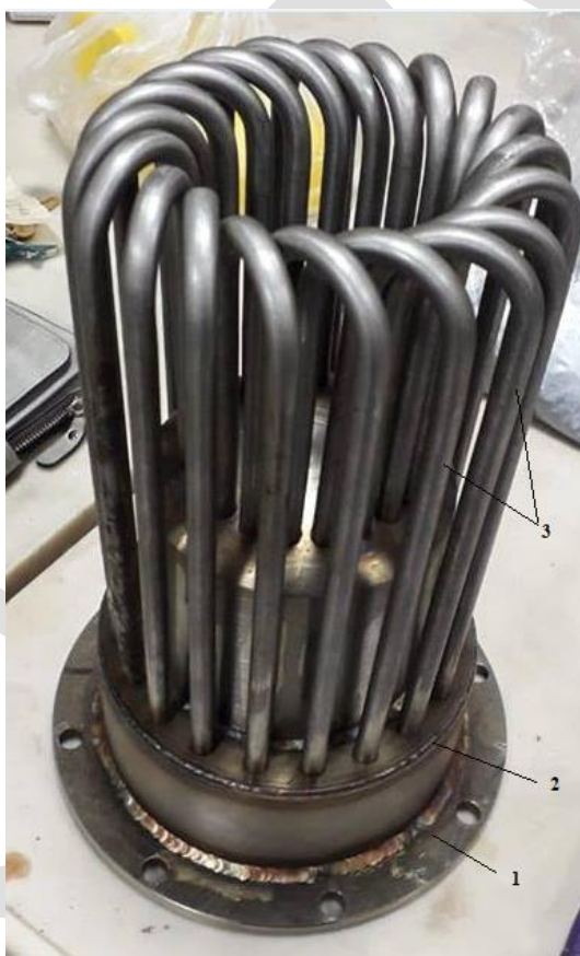
Рисунок 2.1 - Схема теплообмінника з U - подібними трубками
