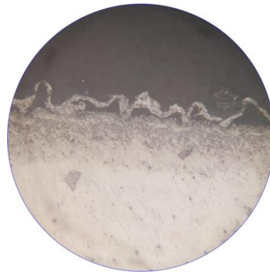
Рисунок 3.4 - Структура поверхневого шару до травлення
