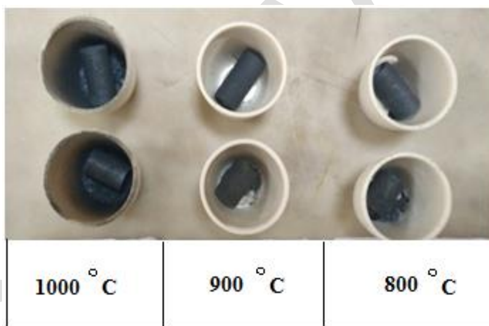
Рисунок 3.6 – Фото зразків після проведення випробувань Результати зважування наведені в таблиці 3.9.
