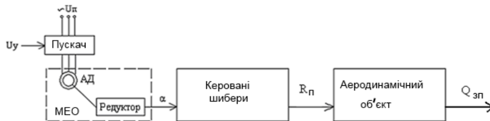
Рисунок 4.4 – Функціональна схема керування витратами повітря
