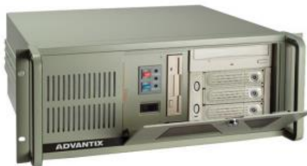
Рисунок 3.21 – Станція оператора АСУ AdvantiX IPC-SYS1-3-A9
