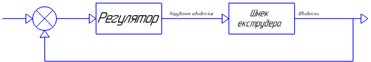
Рисунок 2.4 – Структурна схема керування діаметром хвилеводу.
