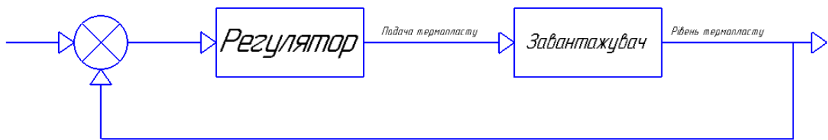
Рисунок 2.6 – Структурна схема регулювання надходженням сировини в бункер.
