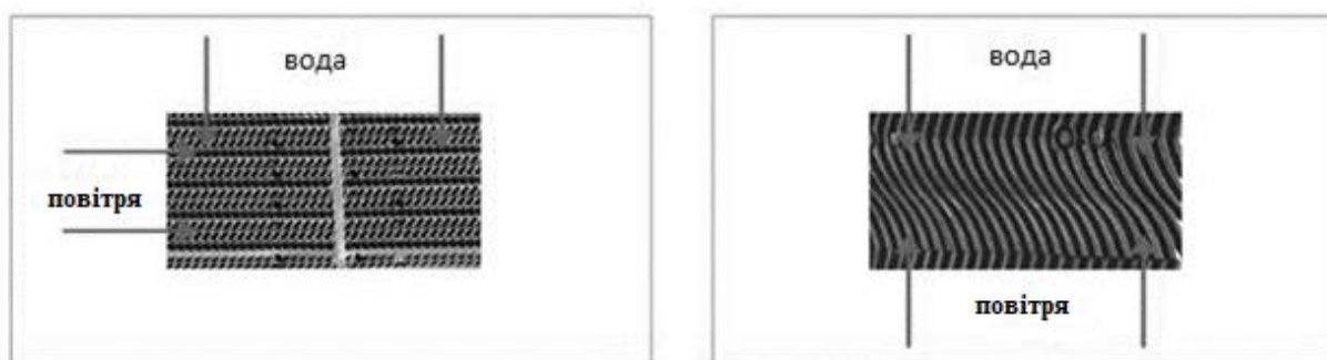
Рисунок 1.4 - Поперечний струм і протитечія води і повітря через зрошувальний блок
