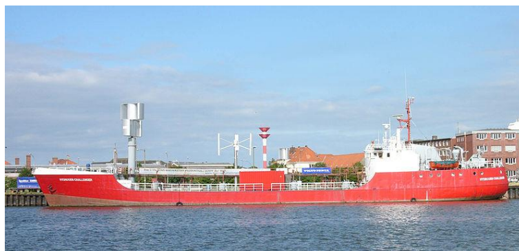
Рисунок 6.40 – Немецкий танкер Hydrogen Challenger (водород производится на борту за счёт энергии ветра) (Водородный транспорт, 2017)
