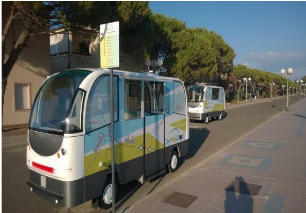
Рисунок 7.28 – Безпілотний автобус на вулицях Орістано (Какой будет, 2017).
