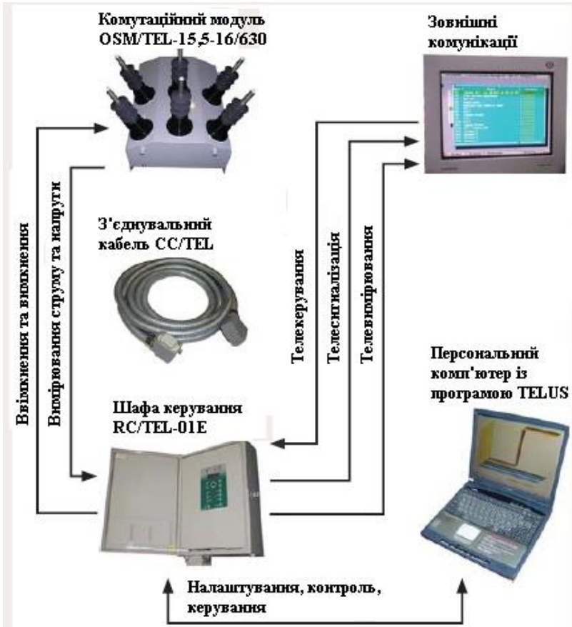
Рисунок 2.61 – Функціональна схема реклоузера типу РВА/TEL
