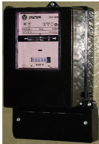
Рисунок 6.7. – Трифазний індукційний лічильник реактивної енергії типу CP4-5002
