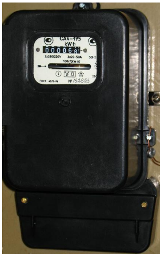
Рисунок 6.6 – Трифазний індукційний лічильник активної енергії типу CA4-195
