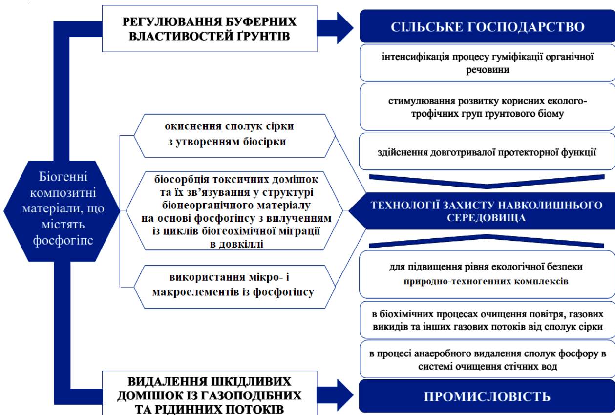
Рисунок 9 – Блок-схема напрямів використання фосфогіпсу як вторинного ресурсу в технологіях захисту навколишнього середовища з урахуванням еколого-синергетичних механізмів
