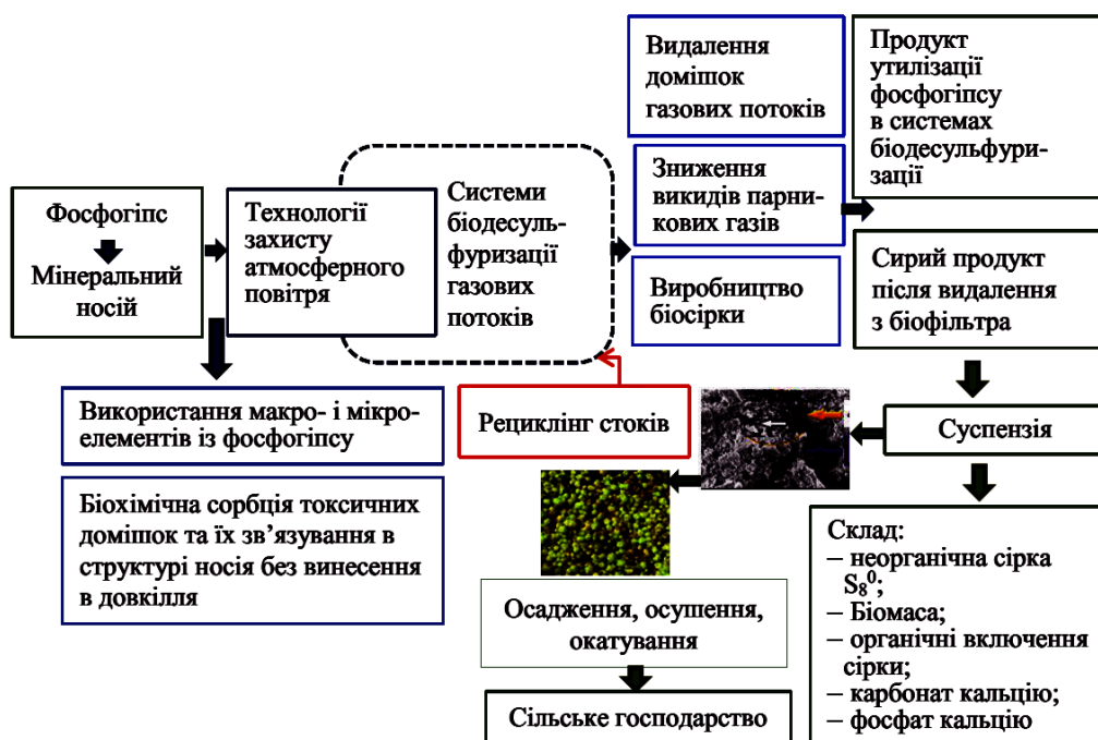
Рисунок 16 – Принципова схема екологічно безпечних процесів утилізації фосфогіпсу як мінерального носія в системах біохімічного очищення
