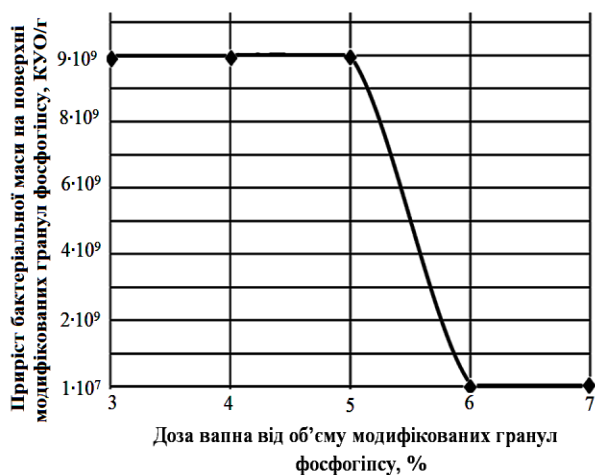
Рисунок 11 – Залежність приросту бактеріальної маси від додавання дози вапна при формуванні модифікованих гранул фосфогіпсу
